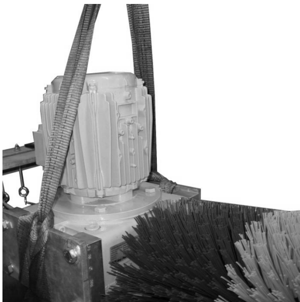
Illustration 3: Fixation de la sangle de levage
