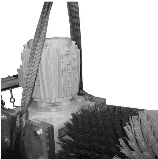
Abbildung 3: Befestigung des Hebegurtes
