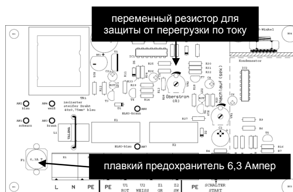
Рис. 5: Схема распределительной коробки
